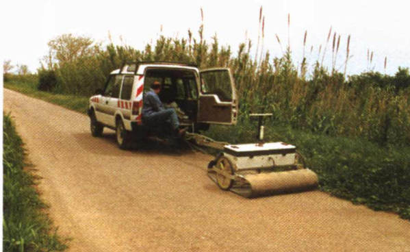
Photo 6.1 – Prospection géophysique par la méthode radio-magnétotellurique (RMT) en crête de la digue de l'Agly.
