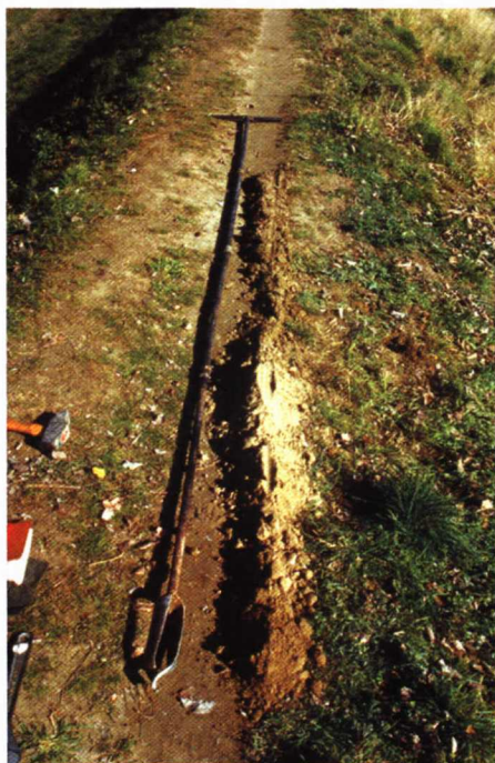
Photo 6.5 – Sondage à la tarière manuelle dans un corps de digue limono-sableux de Camargue.
