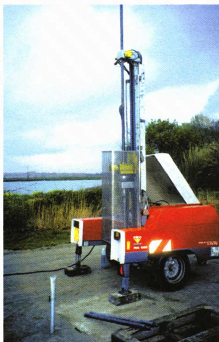
Photo 6.4 – Pénétrromètre dynamique PDG 1000 mis en station pour un sondage.
