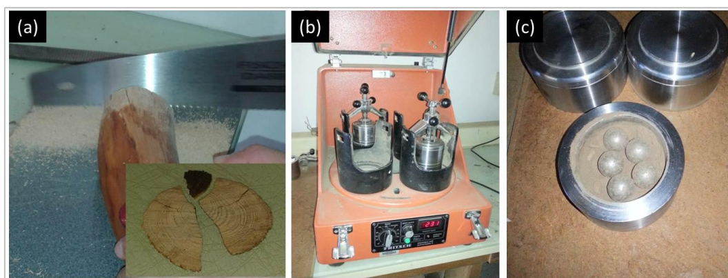
Figure 36. Illustration du protocole de broyage (a) obtention de rondelles fines (b) broyage des morceaux de racines dans broyeur planétaire (c) sciure obtenue (photo : Bambara G., 2013)
