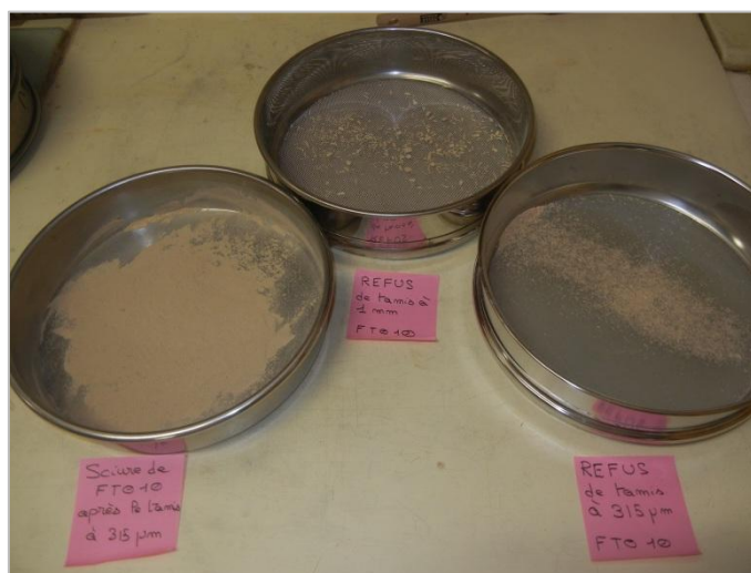
Figure 37. Tamisage des échantillons de racines préalablement broyés : illustration des refus de tamis et obtention d'une sciure de granulométrie inférieure à 315\mu\text{m} (à gauche) (photo : Bambara G., 2013)
